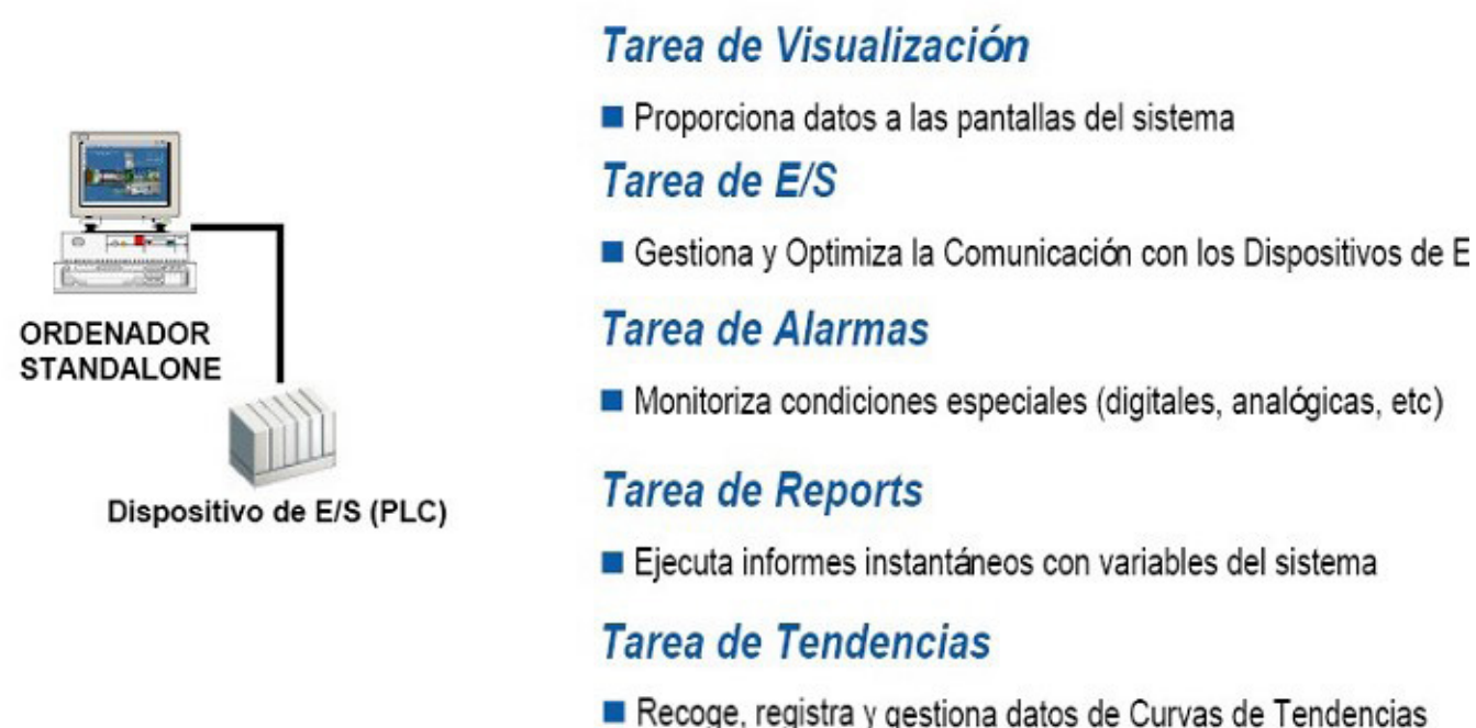
Fig. 1. Tareas de supervisión con Citect SCADA. Fuente: Autores.
