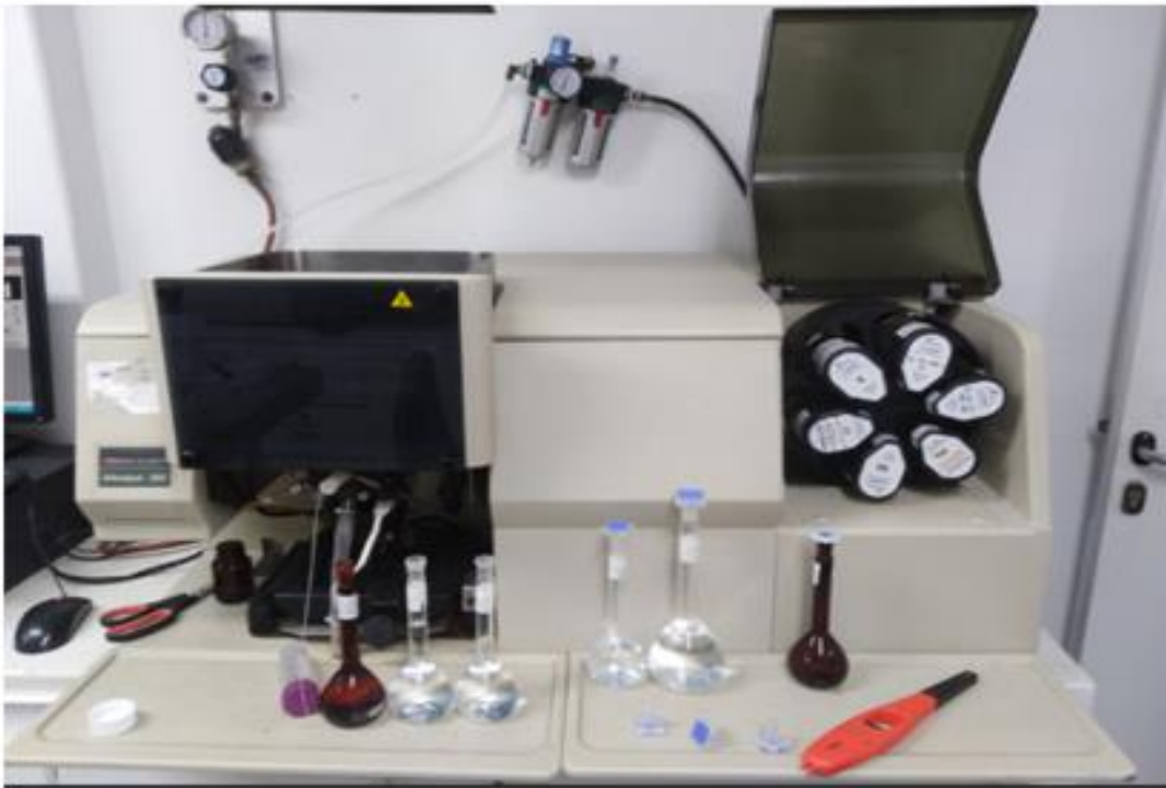
Equipo de absorción atómica a 248,3 nm utilizando una lámpara de cátodo de hierro
