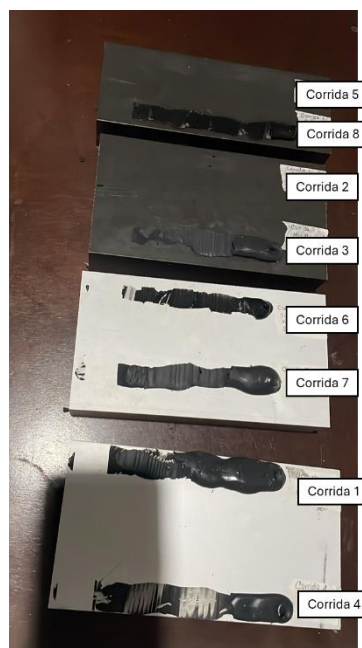
Imagen 7. Resultado de las corridas en la prueba de adherencia. Fuente. Autores.
