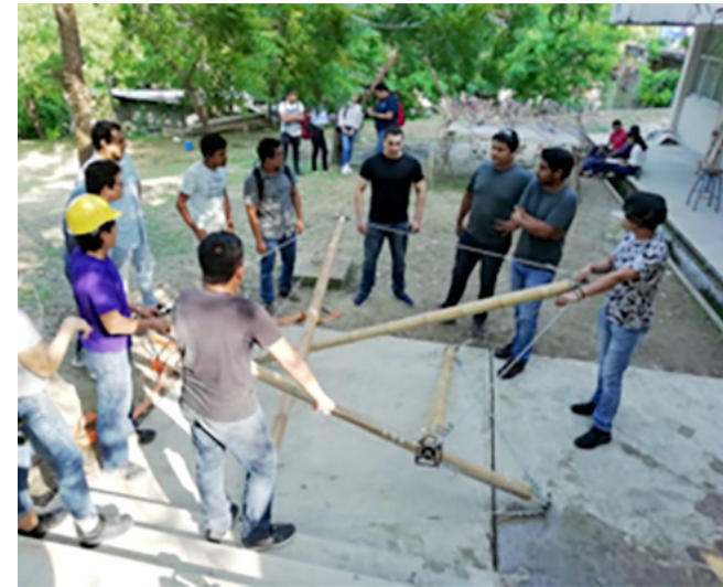
FIGURA 40. Armado terminado y prueba de carga empírica.
